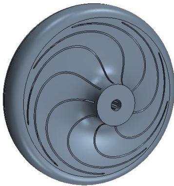
Рисунок 1 – 3D - модель направляющего аппарата с безлопаточным диффузором
