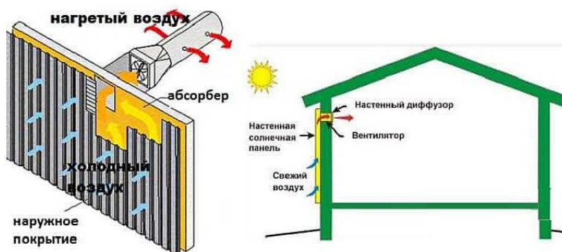
Рисунок 2 – Схема воздушной системы солнечного теплоснабжения
