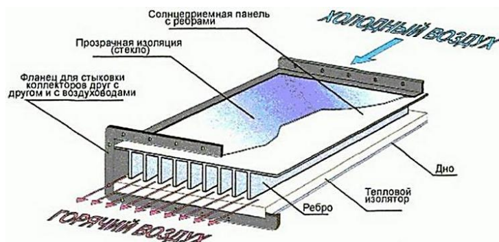
Рисунок 1 – Схема воздушной системы солнечного коллектора
