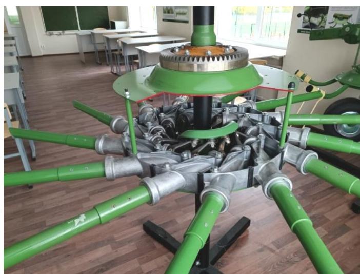
Рисунок 5. Имеющиеся в лаборатории стенды и плакаты: а – настенные плакаты; б – ротор ворошителей KW; в – ротор 3600 валкователей Swadro
