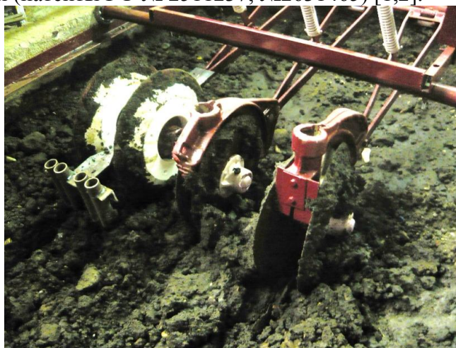
Рисунок 1 – Экспериментальный бороздоформирующий рабочий орган в почвенном канале
