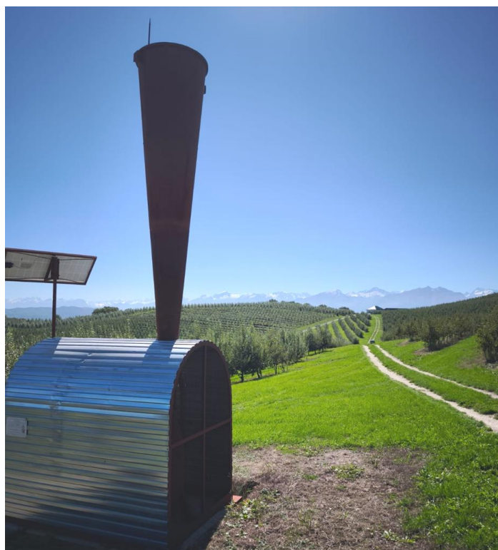
Рисунок 3. Градозащитная установка в саду с. п. Аушигер Figure 3. Nail protection installation in the garden of the rural settlement of Aushiger
