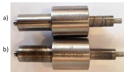
Рисунок 2. Распылитель (а) модернизированной и (б) серийной форсунки
