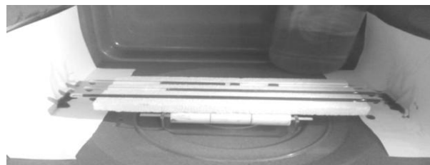
Рисунок 2. Модель капилляра сырья в микроволновом генераторе
