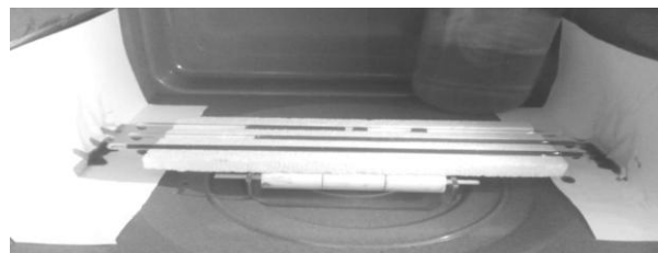
Рисунок 2. Модель капилляра сырья в микроволновом генераторе
