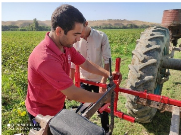
Рисунок 2. Электроискровое устройство для чеканки верхушек хлопчатника Figure 2. Electric spark device for minting cotton tops
