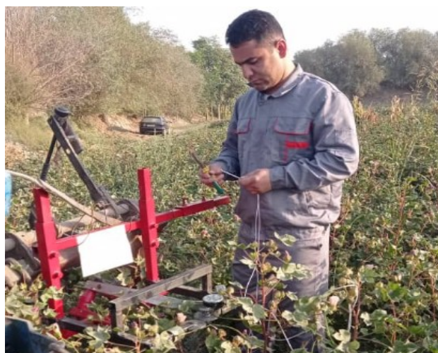
Рисунок 3. Электромеханическое устройство для чеканки верхушек хлопчатника Figure 3. Electromechanical device for minting cotton tops
