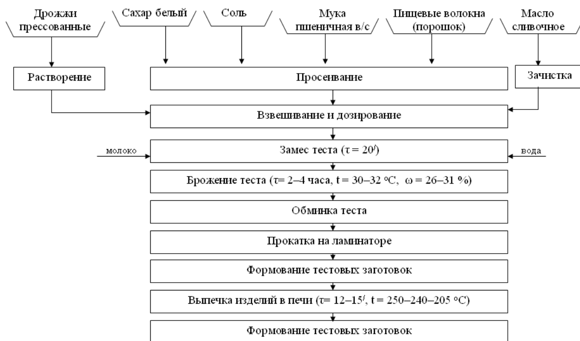
Рисунок 3. Технологическая схема производства галет с использованием пищевых волокон Figure 3. Technological scheme for the production of biscuits using dietary fiber
