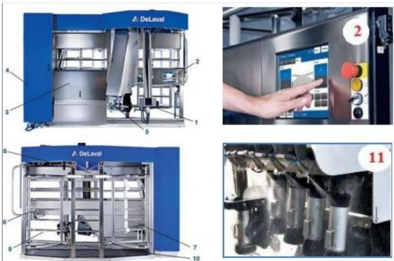
Рисунок 1 – Доильная станция ДеЛаваль VMS:
