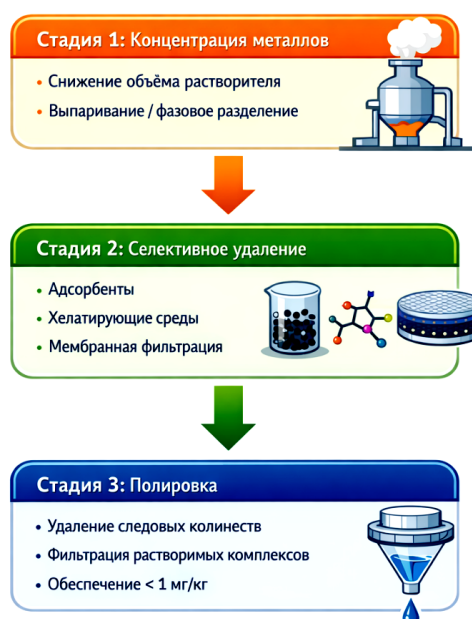
Рисунок 1 – Многоступенчатый механизм удаления металлов из коллагеновых гидролизатов
