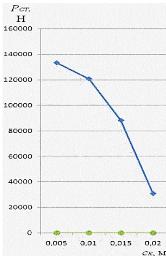
Рисунок 5. Закономерности смены сопротивления почвы разрыхлению P_{СТ} в зависимости от толщины консоли С_K Figure 5. Patterns of changes in soil resistance to loosening depending P_{СТ} on the thickness of the cantilever С_K
