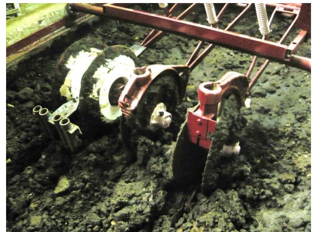
Рисунок 1 – Экспериментальный бороздоформирующий рабочий орган в почвенном канале
