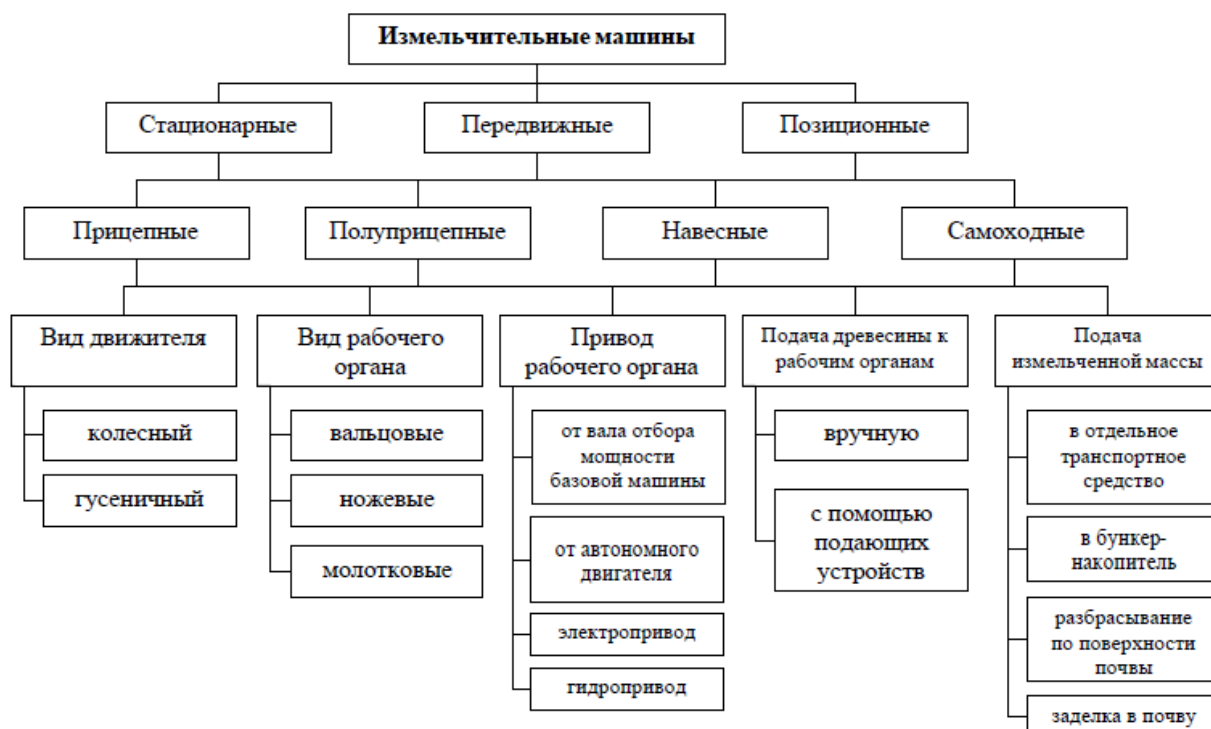
Рисунок 2. Классификация машин для измельчения древесины Figure 2. Classification of wood chipping machines
