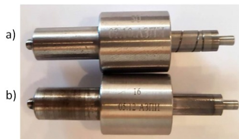
Рисунок 2. Распылитель (а) модернизированной и (б) серийной форсунки
